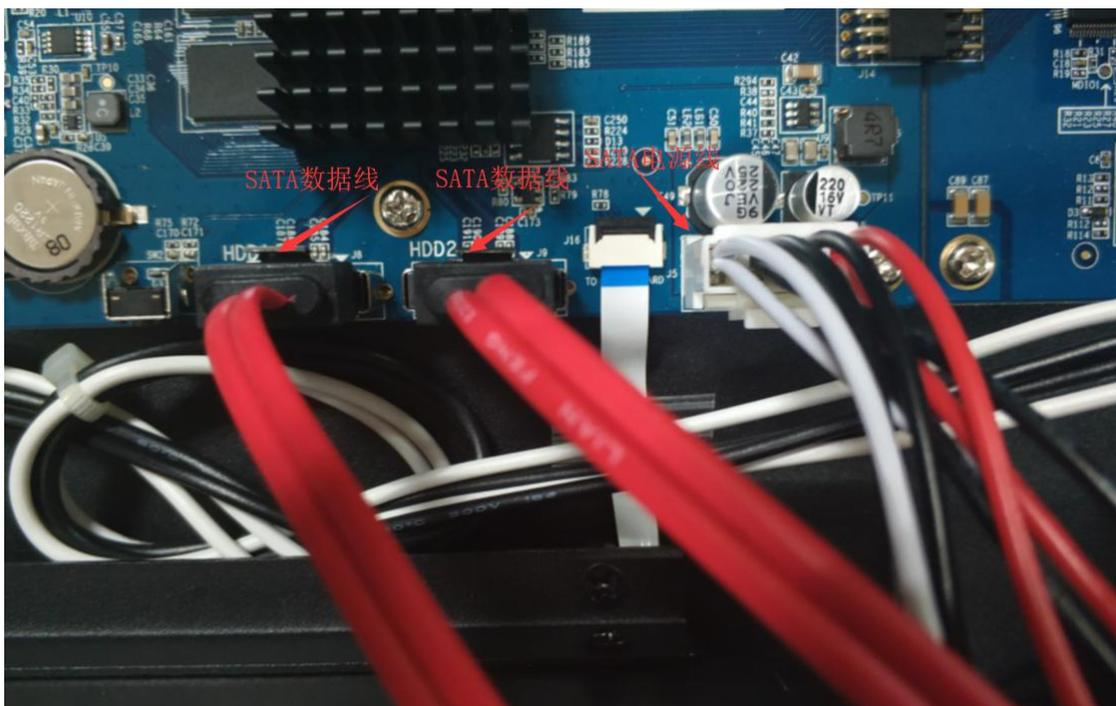
3. 安装硬盘的 SATA 数据线和电源线
