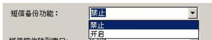
IP MODEM：当设备与网络连接中断后，收到的串口数据将以短信方式发出。
