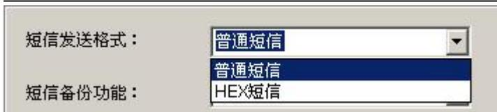
一般短信发送都是发送可见的字符或者汉字，选用 HEX 短信方式可以发送任意的 0x00-0xff 的十六进制数，这种方式特别适合利用短信的方式传送工业控制数据，对工控设备进行监控。
