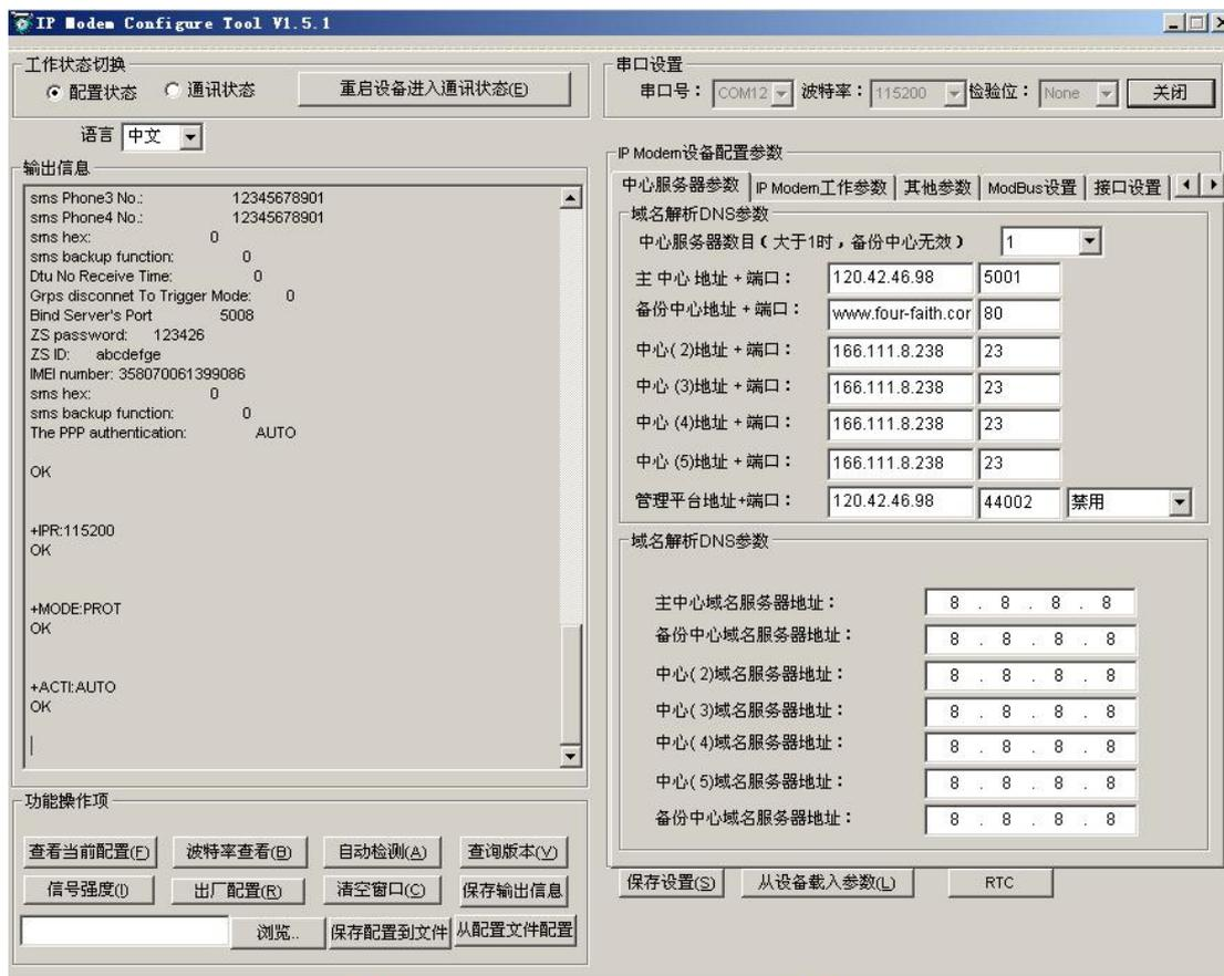
参数配置软件使 IP MODEM 进入配置状态后会自动载入设备中的当前配置参数，并显示在右边的 ” IP MODEM 设备参数配置” 中，至此可以开始配置 IP MODEM 中所有配置参数。
