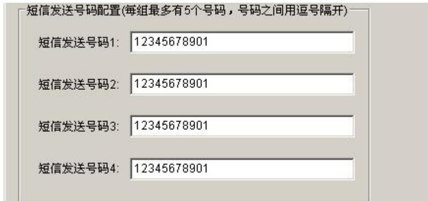
当设备“短信备份”功能开启时，需要设置此参数。设备需要上报的信息将以短息发出（短信的目的号码在此参数设置）。每组可以设置 5 个手机号码，各个手机号码用逗号隔开。每个手机号码的长度不超过 15 个字符。
