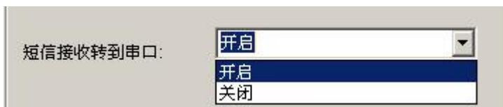
IP MODEM：收到短信后以“手机号，短信内容”的格式往串口输出。
